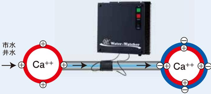
100～10,000Hzの交流電磁界を変換器よりケーブルに与えるとマイナス帯電水となる。カルシウムのプラス表面電位にマイナス電位の陰イオン（シリカ、塩素、硫酸根など）が特異吸着しカルシウムをマスクングします。その結果、管壁のマイナスと同符号のマイナスにより反発分散させ、皮脂とカルシウムによるヌルヌルの発生を防ぎます。陰イオンのマスクングは滅菌効果の持続性と塩素臭防止、塩素注入量の削減ができ、また還元作用により防錆を行います。
